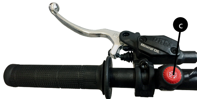
c) Botón Paro, situado a la izquierda del manillar El botón de paro se encuentra situado en el lado izquierdo del manillar, accesible a nuestro dedo pulgar para poder accionarlo con facilidad.
