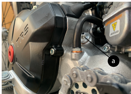
a): Tapón llenado aceite, en la parte superior del cárter.
