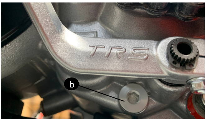
Fig(b): Tapón vaciado aceite, en la parte inferior del cárter
