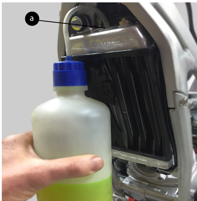
a) Tapón de llenado situado en la parte superior del radiador.
